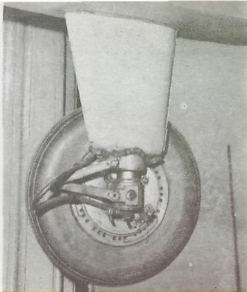
Podwozie główne samolotu Junak 3 (lewe) z osłoną go- leni (fot. Muzeum Techniki w Warszawie)
